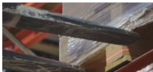
En ljusstark laser visar gafflarnas position i förhållande till godset och ställage
