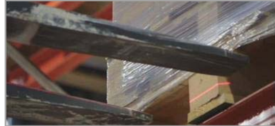
En ljusstark laser visar gafflarnas position i förhållande till gods och ställage.
